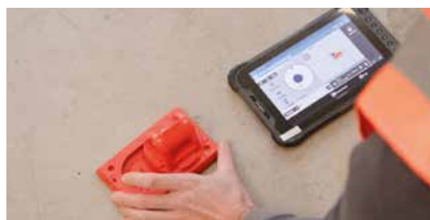
Mueva la ayuda para trazar en la placa base hasta alcanzar la posición objetivo, visible en el círculo verde
