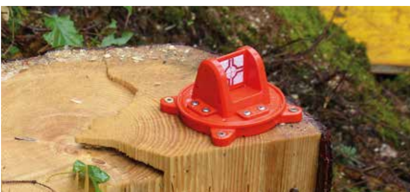
RS193 – Uso en la construcción del puente de Echelsbach como punto fijo durante todo el tiempo de construcción.
