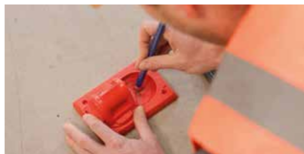
Mueva el prisma hacia un lado y marque la posición del objetivo con un lápiz
