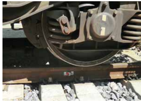
RSMP15 para mediciones con estación total robótica durante la carga.
