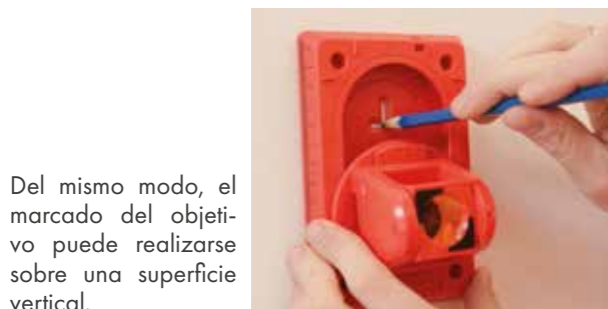
Mueva el prisma hacia un lado y marque la posición del objetivo con un lápiz
