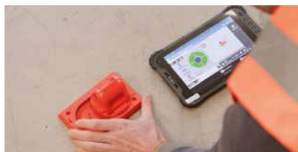
Mueva la ayuda para trazar en la placa base hasta alcanzar la posición objetivo, visible en el círculo verde
